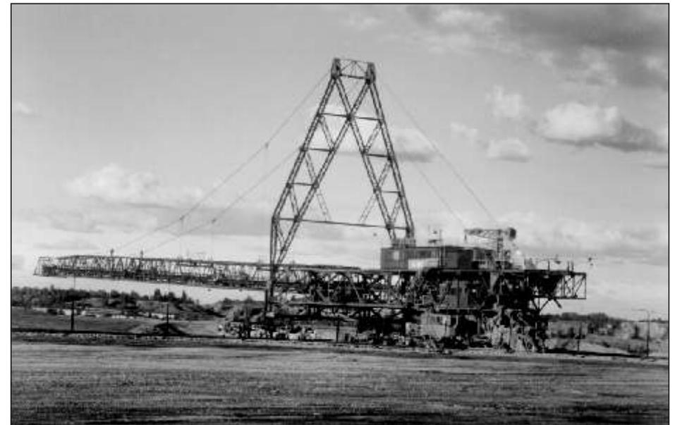
Bild 5 Absetzer im Braunkohletagebau Geiseltal
