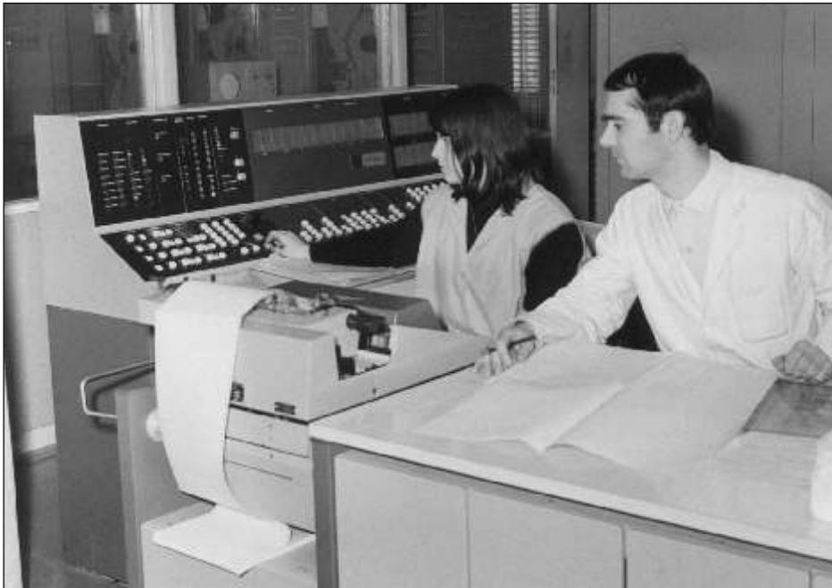
Bild 3 Programmtest an der EDVA R 300; der Test von MOPS-Programmen erfolgt zum Teil schrittweise durch den Programmierer zusammen mit dem Operator über das Bedienpult der Anlage
