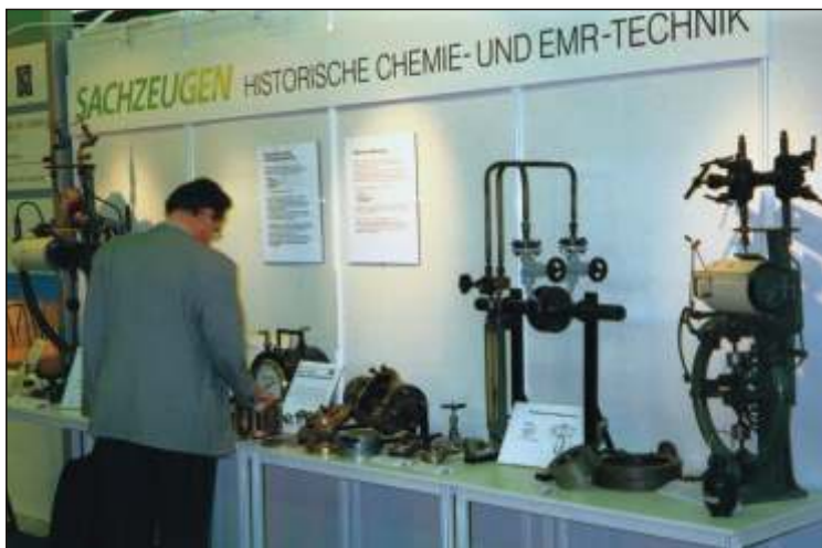
Bild 4 Blick auf den Ausstellungsstand mit einem aufgearbeiteten Teil eines Hochdruckreaktors der Fa. Friedrich Krupp AG, Essen, aus dem Jahr 1924. Der präparierte Schnitt zeigt die Kombination des drucktragenden Mantelrohres mit Bohrungen nach außen und dem Weicheisenkern innen. Diese geniale Idee von Carl BOSCH gestattete es, den chemischen Angriff des Wasserstoffs auf den Stahlmantel abzuwehren. Das präparierte Rohrstück ist Teil eines Hochdruckmantels eines Regenerators der historischen Ammoniak-Synthesenanlagen der Ammoniakwerke Merseburg, später Leuna-Werke.
