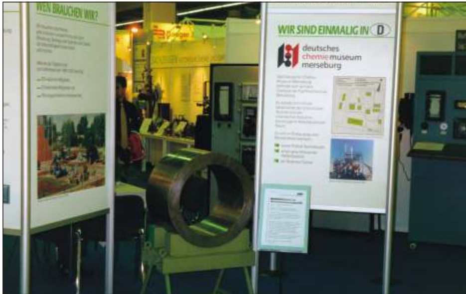
Bild 4 Blick auf den Ausstellungsstand mit einem aufgearbeiteten Teil eines Hochdruckreaktors der Fa. Friedrich Krupp AG, Essen, aus dem Jahr 1924. Der präparierte Schnitt zeigt die Kombination des drucktragenden Mantelrohres mit Bohrungen nach außen und dem Weicheisenkern innen. Diese geniale Idee von Carl BOSCH gestattete es, den chemischen Angriff des Wasserstoffs auf den Stahlmantel abzuwehren. Das präparierte Rohrstück ist Teil eines Hochdruckmantels eines Regenerators der historischen Ammoniak-Synthesenanlagen der Ammoniakwerke Merseburg, später Leuna-Werke.
