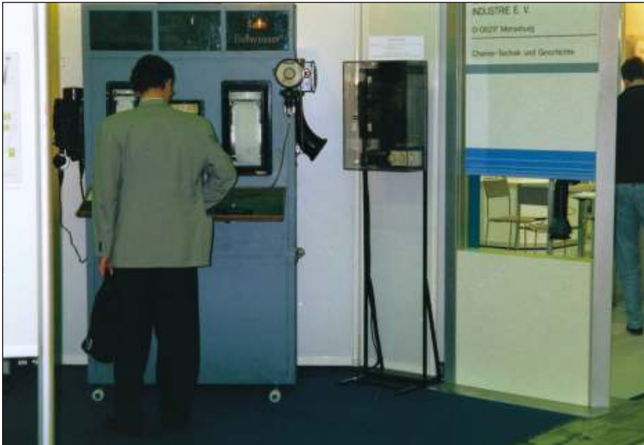
Bild 7 Ein historischer Bedienstand aus den Chemischen Werken Buna mit Anzeige- und Registriergeräten, Signalanlagen, Feldtelefon und integriertem Schreibpult wurde fleißig genutzt.
