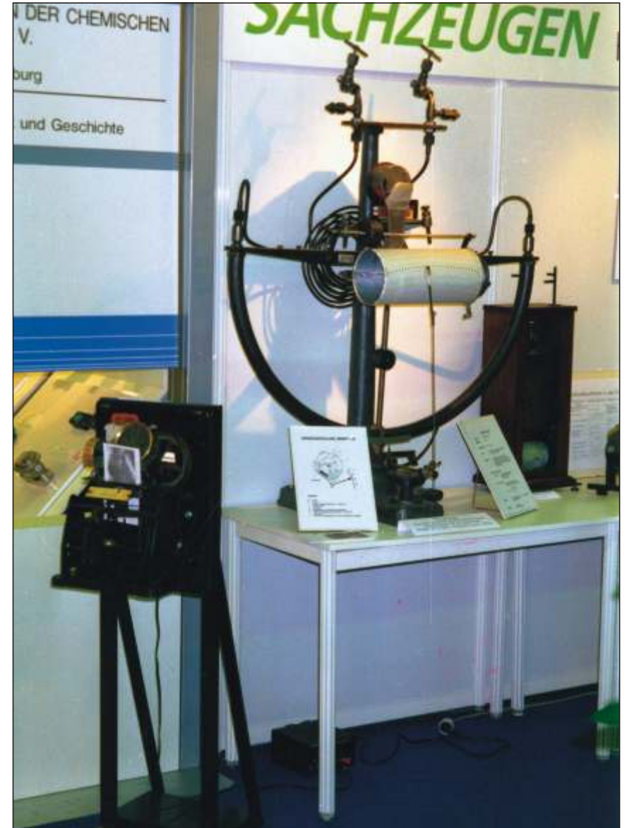
Bild 6 Eine Laborringwaage im Gehäuse und eine Ringwaage großer Abmaße für die Durchflussmessung von Gasströmen fanden großes Interesse bei den Besuchern. Beide waren in den Leuna-Werken im Einsatz und wurden wahrscheinlich auch dort gebaut. Die mechanische Stechuhr im Vordergrund links war stark frequentiert während der Ausstellung.
