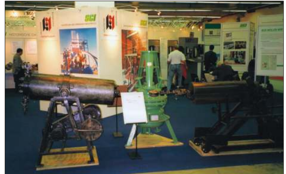
Bild 2 Blick auf den Ausstellungsstand mit drei Autoklaven im Vordergrund. (Links und rechts: Dreh- und Schwenkautoklaven aus dem Eigenbau der ehemaligen Leuna-Werke, Mitte: Rührautoklav aus den ehemaligen Chemischen Werken Buna Schkopau, hergestellt von Chemische Maschinenwerke Rudisleben 1967)
