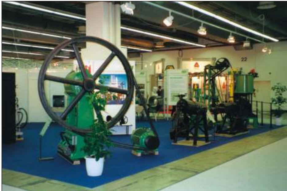
Bild 1 Blick auf den Ausstellungsstand, im Vordergrund links eine Hochdruck-Einspritzpumpe der Firma Balcke, Frankenthal. Diese Pumpe war von 1936 bis 1994 zur Förderung flüssiger Produkte der Hochdruck-Hydrierung im Buna-Werk Schkopau im Einsatz.
