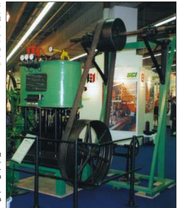
Bild 2 Blick auf den Ausstellungsstand mit drei Autoklaven im Vordergrund. (Links und rechts: Dreh- und Schwenkautoklaven aus dem Eigenbau der ehemaligen Leuna-Werke, Mitte: Rührautoklav aus den ehemaligen Chemischen Werken Buna Schkopau, hergestellt von Chemische Maschinenwerke Rudisleben 1967)
