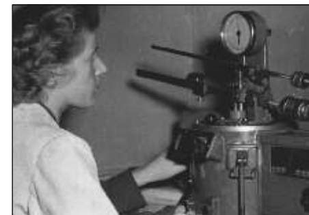
Bild 31 Frau LOSSNER am Defo-Gerät bei der Messung der Mischungsplastizität an allen Mischungstypen zu einer Hauptarbeitsrichtung im Forschungsbereich. Die immer weiter verbesserten Festigkeitsträgervarianten erforderten Austestungen und z.T. konstruktive Veränderungen am Reifen [14].
