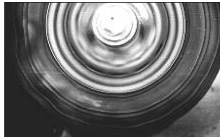
Bild 33 Aufnahme aus der Entwicklung des 1. Riesaer Radialreifens (1968). Stehende Welle bei 220 km/h
