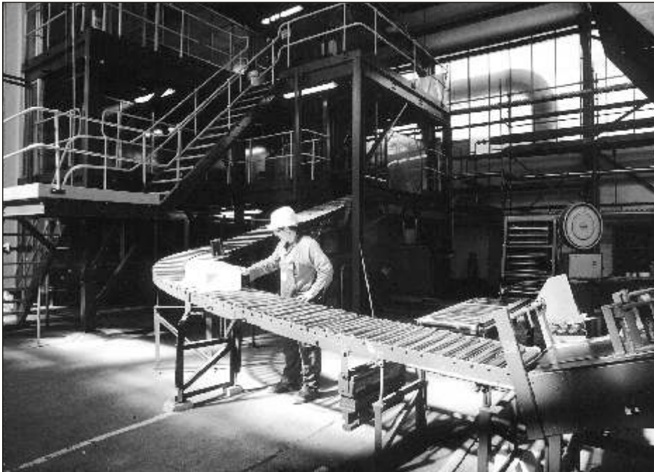
Bild 4 Teil der Aufarbeitung der 1,4 CIS Polybutadienanlage (Transportweg von der Ballenpresse in die Verpackung in der Buna CIS 132 Produktion)
