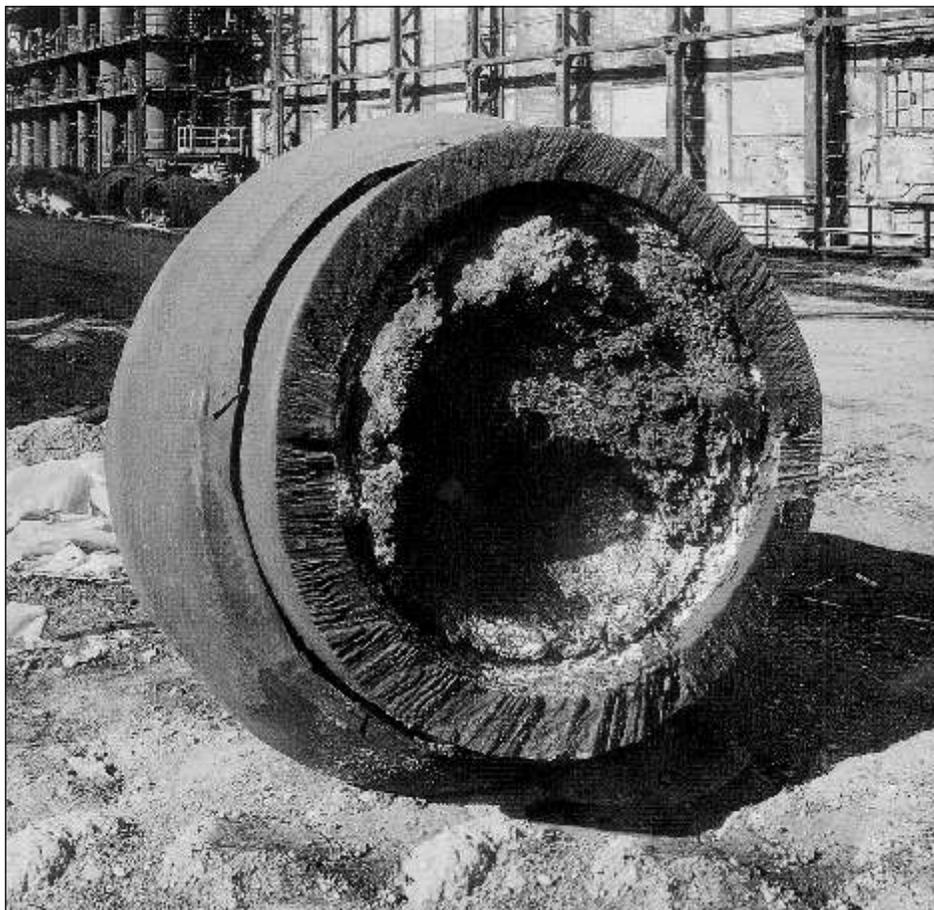
Bild 3 Blick auf den durchschnittenen Methanisierungsreaktor
