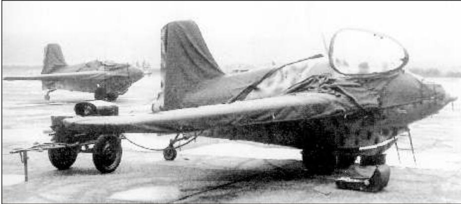
Bild 3 Wasserdichte Überzüge schützten vor allem die Tragflügel aus Sperrholz vor destabilisierender Nässe
