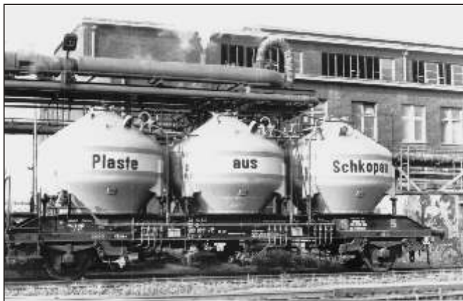
Bild 29 Ucy-Wagen, Behälterwagen für staubförmiges oder granuliertes Produkt
