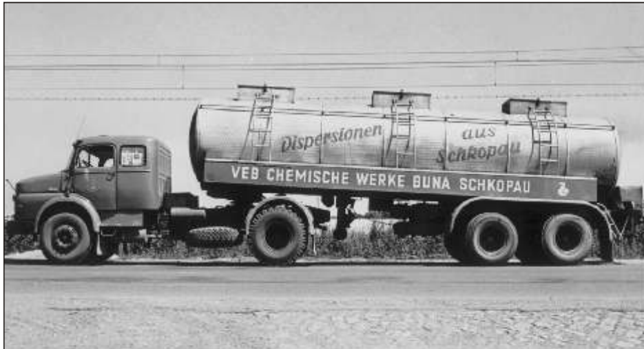
Bild 47 Einer der ersten Tankzüge mit Mercedes-Zugmaschine, Nutzlast 15 t
