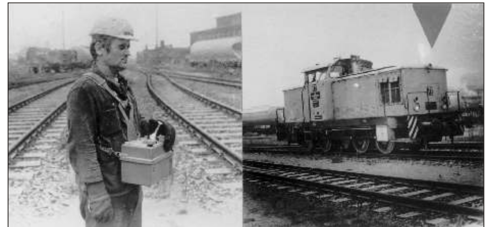
Bild 35 Erstes Funkfernsteuerungsgerät für Lokomotiven in der DDR, hier für die Rangierlokomotive 72
