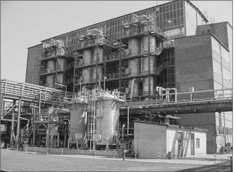
Bild 4 Die Entmonomerisierungskolonnen in der ESBR-Polymerisation
