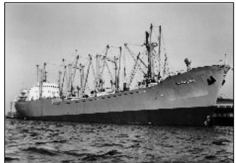
Bild 1<sup>o</sup> Der Massengutfrachter MS 'Altmark' (Baujahr 1959, 4.734 BRT, Länge: 121,58 m, Breite: 16,30 m, Tiefgang: 6,32 m)
