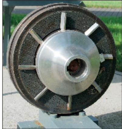
Bild 8 Unterwassergranulator (Exponat 358, vgl. Bild 1 links) Bild 9 Detail Lochscheibe
