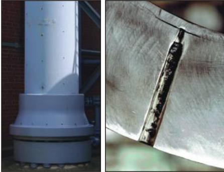
Bilder 7 a,b a) Mantel mit "Bosch"-Löchern, b) Schnitt durch eine Ofenwand mit Weicheisenkern
