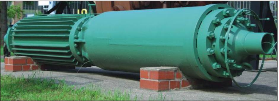
Bild 25 Elektromotor und Turboverdichter der Maulwurfpumpe im Technikpark des DChM
