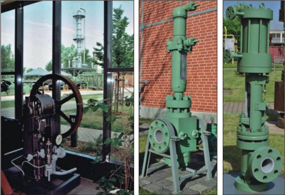
Bilder 26 a-c a) Ölpumpe b,c) ölgesteuerte Schieber/Ventile
