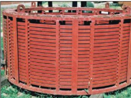
Bild 11 Magnetisierungsspule im Technikpark des DChM
