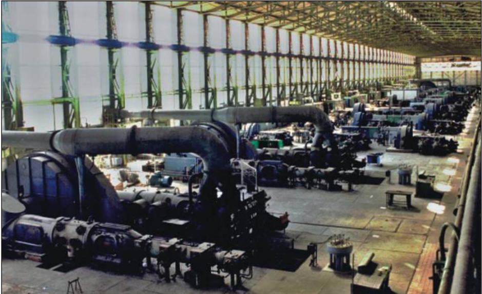
Bild 2 Verdichterbau Me 165 für die Wasserstoffkomprimierung (vorn und ganz hinten die letzten großen Kolbenverdichter, 1998)
