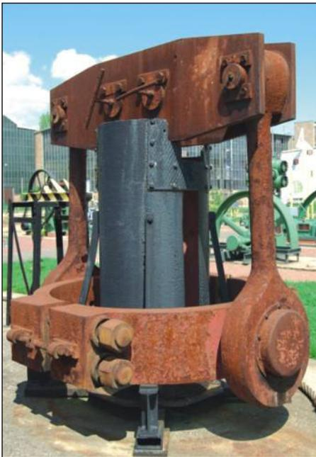
Bild 8 Ringtraverse zum Einsetzen der Ammoniaköfen in die Kammern
