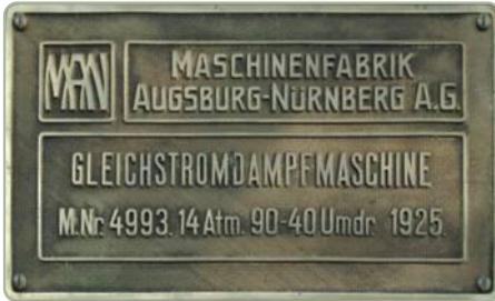
Bild 16 Firmenschild der Dampfmaschine der Kolbenumlaufpumpe (vgl. Bild 14 b)
