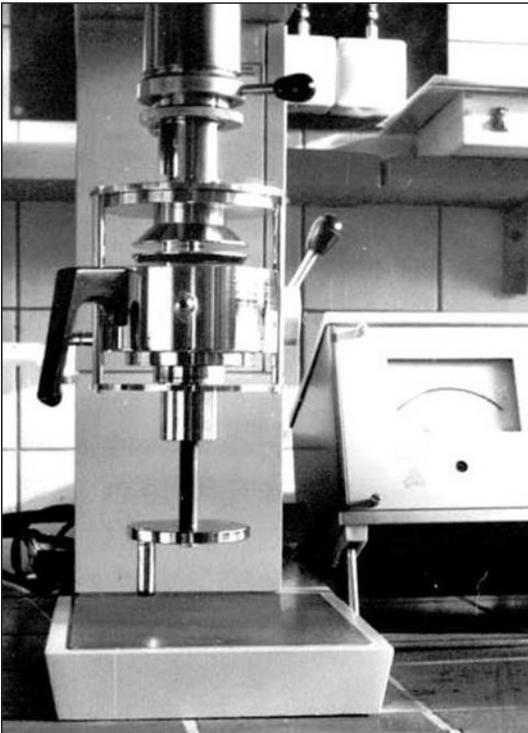
Bild 6 Scheibenrheometer, 1987 [6]
