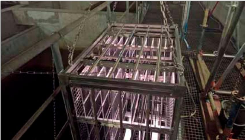
Bild 5 MOL<sup>®</sup> LIK-Katalysatormodul zur Durchlaufbehandlung von bis zu 2000 m<sup>3</sup>/h Wasser [29]
