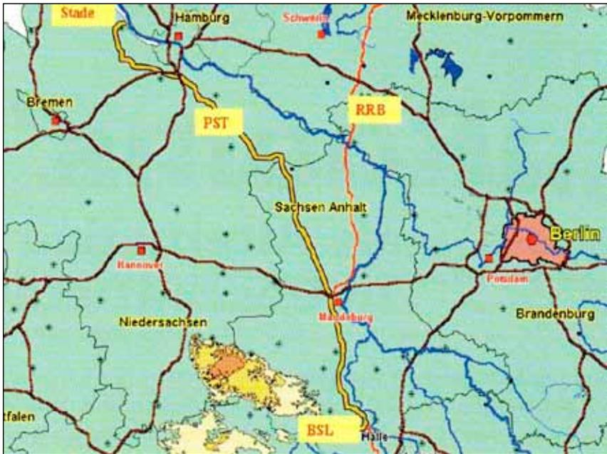
Bild 10 Karte des Trassenverlaufes der Pipeline Stade – Teutschenthal (PST, daneben rot eingezeichnet die Rohrleitung Rostock-Böhlen RRB, vgl. Bild 26 auf Seite 36) [8b]
