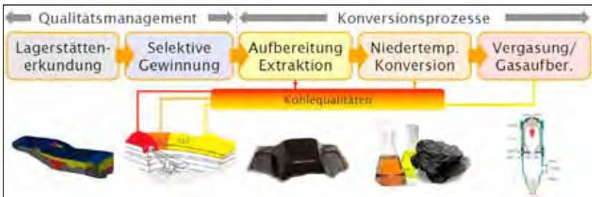
Bild 3 Prozessstufen der stofflichen Nutzung der Braunkohle [5]
