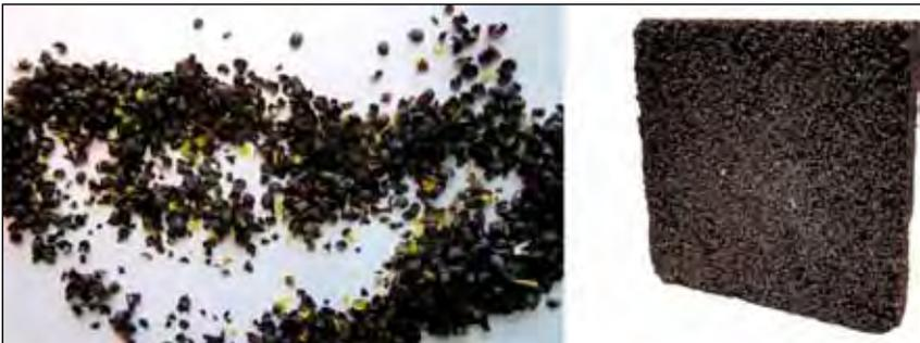
Bild 3 Ausgangsmaterial Rapsschalen (links) und daraus hergestellte Dämmstoffplatte (rechts)
