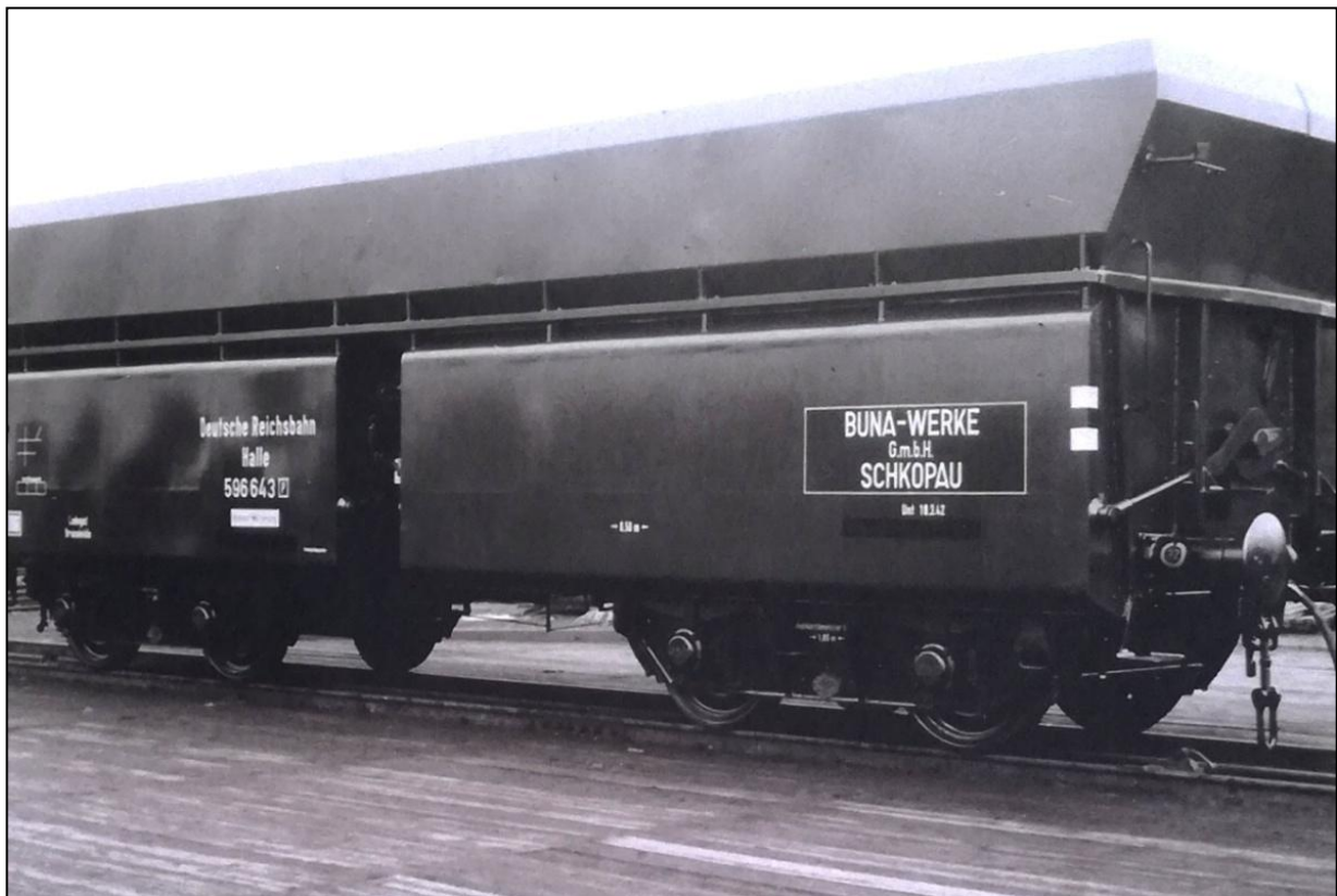
Bild 3 OOt-Wagen der Firma Waggonbau Gotha (Selbstentlader, Buna-Werke G.m.b.H., um 1937)
