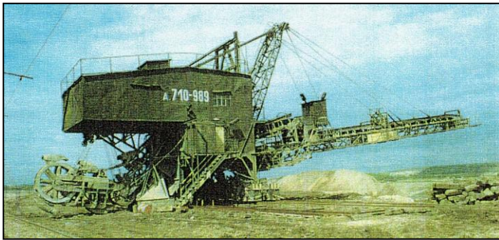
Bild 12 Absetzer 989 A 710 (Baujahr 1925, verkippte Abraum bis Anfang 1993 im Tagebau Mücheln/Südfeld unterhalb der Ortslage Neubiendorf) [4a]
