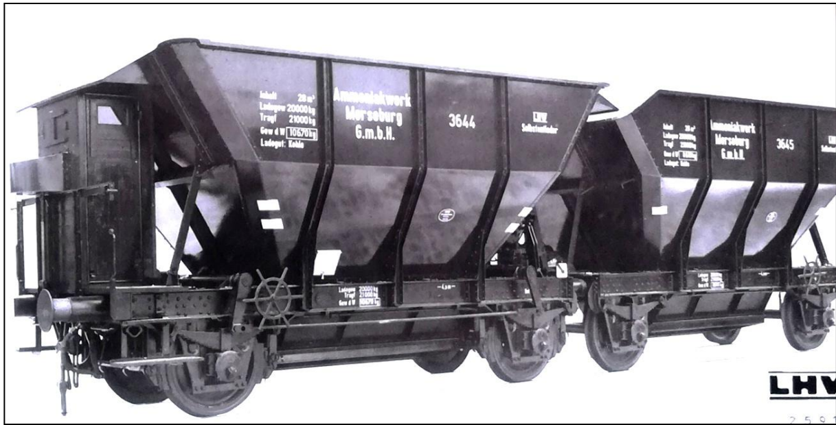
Bild 2 Doppel-Talbot-Wagen der Firma Talbot Aachen (Selbstentlader, Kennzeichnung: Ammoniakwerk Merseburg G.m.b.H., um 1937)
