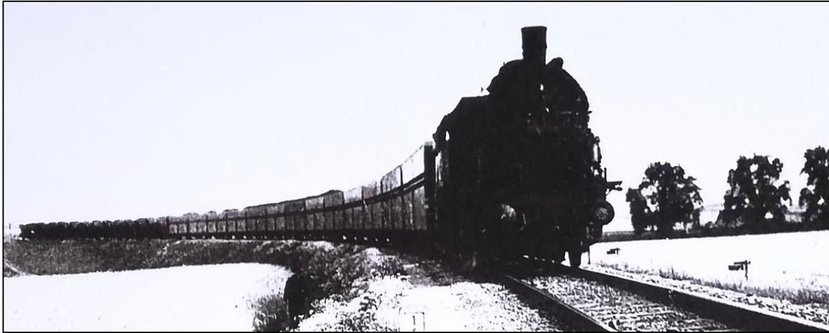
Bild 5 Kohlezug auf dem Verbindungsgleis (km 1,4 Anschlussgleis in das Buna-Werk mit 13 Wagen vom Typ OOt/vorn und 7 Doppel-Talbot-Wagen/hinten, Lokomotive 93 793, Ende 1940er Jahre)
