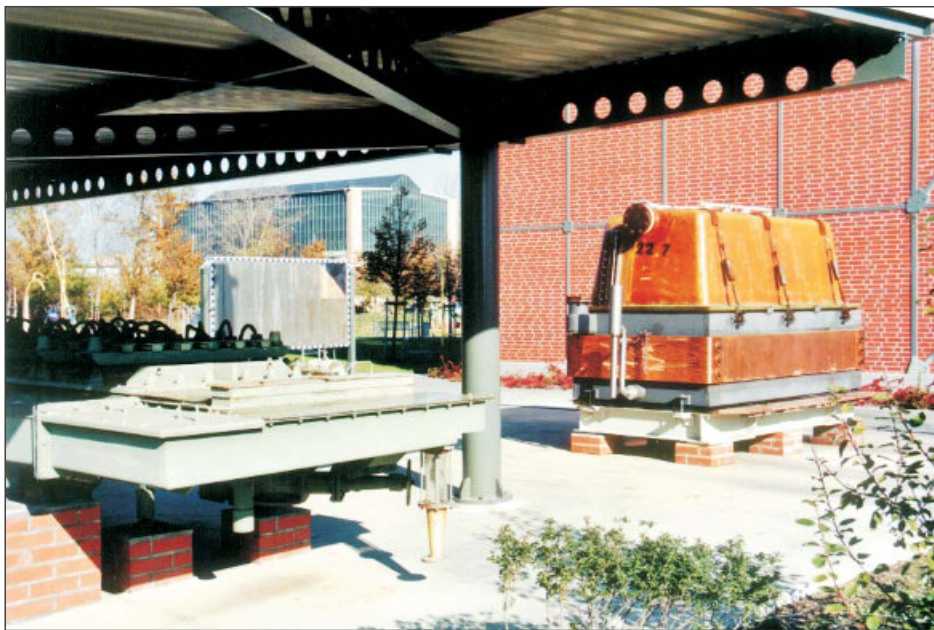
Bild 1 Blick auf den Chlorkomplex im Technikpark mit Amalgamzelle (links), Diaphragmazelle (rechts) und Elektrodenpaar aus einer Membranzelle (Hintergrund Mitte)
