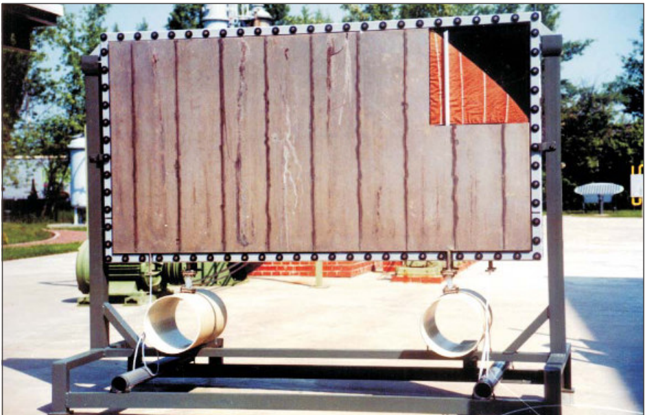
Bild 4 Elektrodenpaar mit Membran
