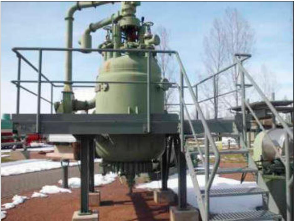
Bild 3 Im Technikpark des DChM ausgestelltler vertikaler 1,6 m<sup>3</sup>-VC-Suspensionspolymerisationsautoklav (früherer Standort: Buna-Werke Schkopau, Bau F 59)
