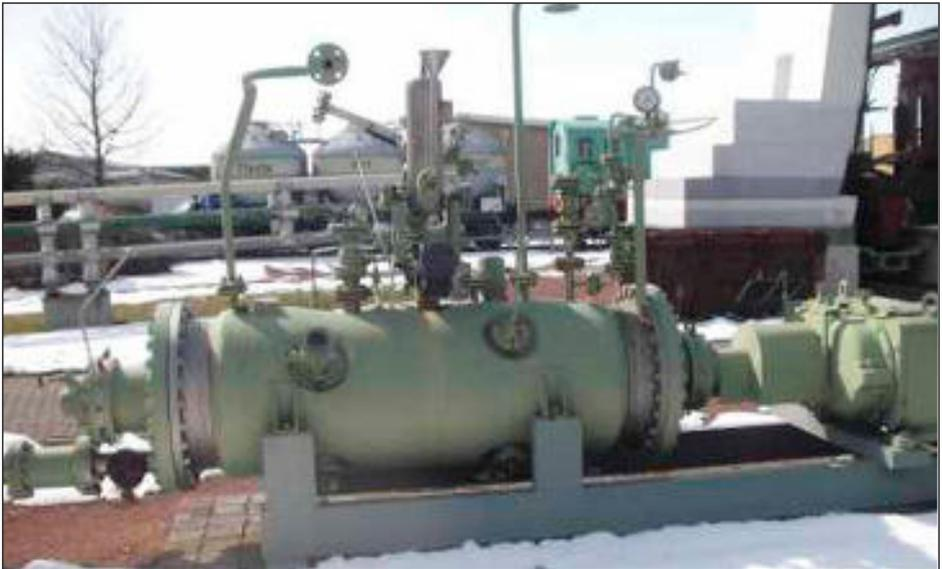
Bild 2 Im Technikpark des DChM ausgestelltter horizontaler 0,4 m<sup>3</sup>- Polymerisationsversuchsreaktor (Länge des Behälters: 2,00 m, mit Stopfbuchse 3,30 m, Durchmesser: 0,80 m, früherer Standort: Buna-Werke Schkopau, Bau F 59)
